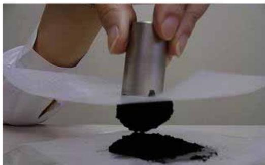
無機多孔質体は水に溶解している物質を吸着する性質があります。例えば活性炭に磁性粒子を結合させた**磁性活性炭(MAC)**は水に溶解している**不純物**をよく吸着して磁石によって分離することができます。
