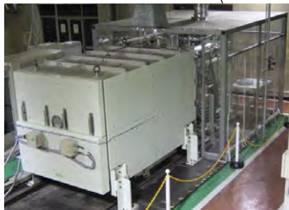
水素製造システム試験機 (2017) 10kW
