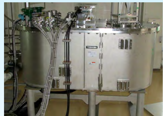
東北大学向け25T磁石 (世界最高磁場)
