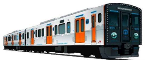
ハイブリッド車両(ディーゼル発電+電動モータ駆動) (JR九州)
