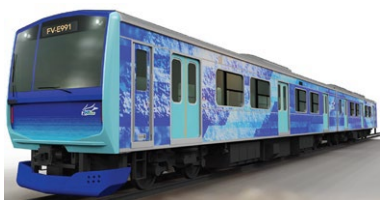
ハイブリッド車両(燃料電池)試験車両(JR東日本) HYBARI (HYdrogen-HYBrid Advanced Rail vehicle for Innovation)
