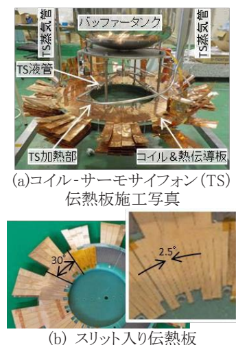
Fig.2 MgB 2 ダブルパンケーキコイルの冷却構造詳細
