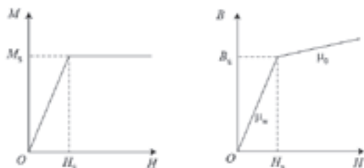
Fig. 1. M - H and B - H curves of SUS wire
