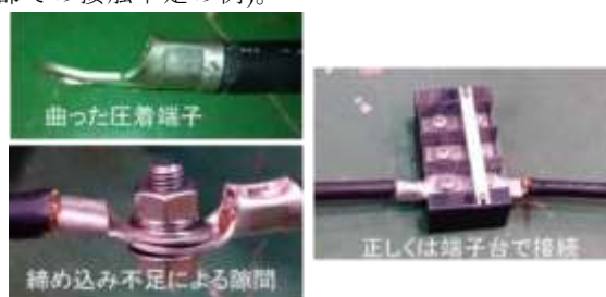
図 2-1 ケーブル接続部での接触不足の例
