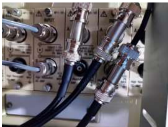
図 2-4 BNC 分岐コネクタによるチャンネル間ショート
