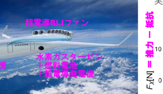
図1 コア分離型・電動推進航空機(JAXA)
