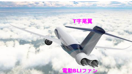
図3 TRA JADCが検討。胴体後部は電動BLIファンを多数配置。57ARC-ABELに基づき検討。
