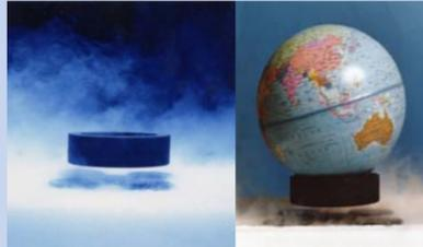
磁石同士を対向させると互いがくっつくか反発して、両者は安定位置で対峙できません。これに対し、超電導の特性を利用すると安定した磁気浮上ができます。これが、超電導(磁気浮上)コースターの原理です。
